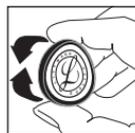
Esaminare visivamente la ghiera per verificare che il bordo flessibile sia inserito in modo uniforme. Se necessario, piegare il gruppo, tenendo il bordo esterno della ghiera fra le dita. Ruotare il gruppo di un quarto di giro e ripetere l'operazione di piegatura.
