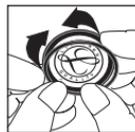
Inserire il bordo flessibile del diaframma nella scanalatura della ghiera. L'operazione riuscirà meglio iniziando con la ghiera posizionata al di sopra della faccia leggibile del diaframma.
