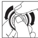
Con la punta di un dito, applicare un po' di talco in polvere alla superficie interna del bordo flessibile del diaframma. Questa precauzione agevolerà il montaggio e permetterà un'alternanza uniforme e silenziosa di alte e basse frequenze. Con le dita, togliere poi gli eventuali residui di talco dal diaframma.
